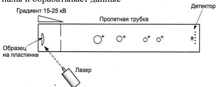
Рис. 9.11. Принцип работы времяпролетного масс-анализатора (TOF, time-of-flight). Ионы движутся к детектору через трубку, причем более легкие ионы движутся быстрее, более тяжелые — медленнее. Если ионы ускоряют путем наложения одного и того же потенциала E фиксированной точке и в фиксированный начальный момент времени, они разделятся в соответствии со значениями m/z . Время нахождения ионов в пути можно перевести в значения масс. Обычно для построения хорошего спектра требуется несколько сотен импульсов лазера, продолжительность каждой вспышки составляет несколько наносекунд. С помощью камеры, отслеживающей вспышку лазера, можно перемещать луч лазера по пластинке с образцов, чтобы найти так называемые «сладкие точки» (sweet spots), в которых состав сокристаллизовавшихся матрицы и образца оптимален для получения наибольшей чувствительности.
